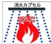
消火カプセル 105℃の熱でマイクロカプセルから消火剤が自動散布
