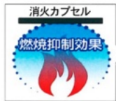
消火カプセル 燃焼抑制効果 酸化した消火剤が酸素供給を遮断し、燃焼を抑制
